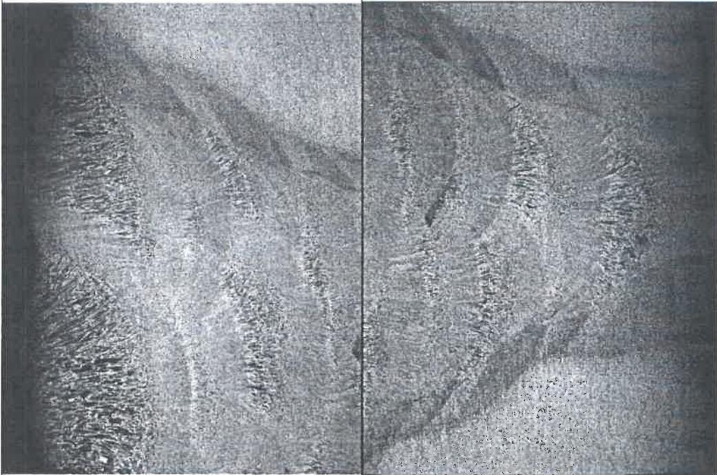
Микроструктура левої частини шва образца х10
